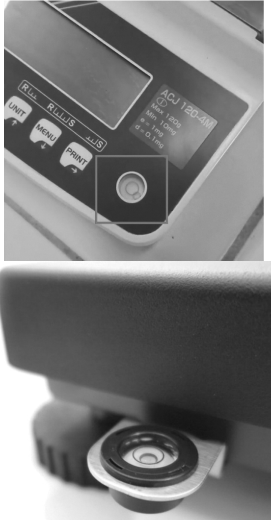
Figure 1.2. Deux exemples de niveau à bulle sur des balances de précision.
